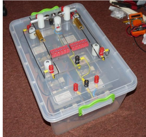
Rys. 4. Układ zasilania Cewki Tesli a) blok transformatorów zasilających, b) gotowy moduł zasilający z układem zabezpieczeń.
