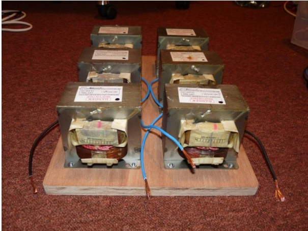
Rys. 4. Układ zasilania Cewki Tesli a) blok transformatorów zasilających, b) gotowy moduł zasilający z układem zabezpieczeń.
