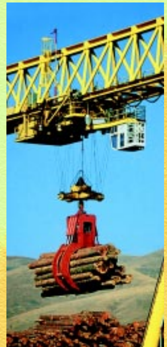
W urządzeniach dźwigowych silnik powinien dysponować bardzo dużym momentem rozruchowym nawet przy zerowej prędkości. Celowe jest tu zatem zastosowanie napędu wektorowego.
