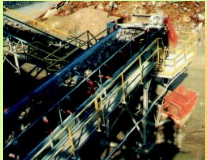
Przenośniki wymagają zastosowania przemiennika częstotliwości do zapewnienia dużego momentu obrotowego i regulacji prędkości obrotowej w zakresie od kilku obr./min do prędkości maksymalnej.
