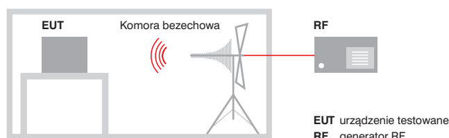
Zasada badania odporności promieniowanej
