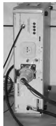
Rys. 6. Schemat zastępczy klasycznej, trójfazowej sieci sztucznej oraz sieć sztuczna SMZ 6/50, 4x25A wykorzystywana do badań instalacji reaktora plazmowego
