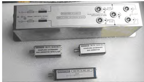
Rys. 5. Sieć CDN 117 do sprzężenia uderów z liniami sygnałowymi i transmisji
