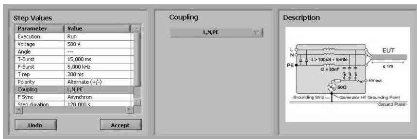
(f) Ustawienie sprzężenia zakłóceń do linii L, N, PE
